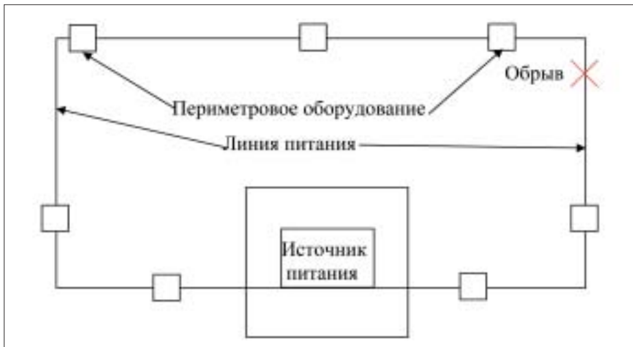
Рис. 4. Схема подключения питающей линии "по кольцу"
